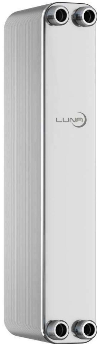
Теплообменники LUNA это пластинчатые паяные теплообменники полностью изготовлены из нержавеющей стали. В результате применения нержавеющей припоя, теплообменник получил материально однородную конструкцию с более высоким уровнем гигиены, а также устойчивость к коррозии, перепадам давления и изменениям температуры.
